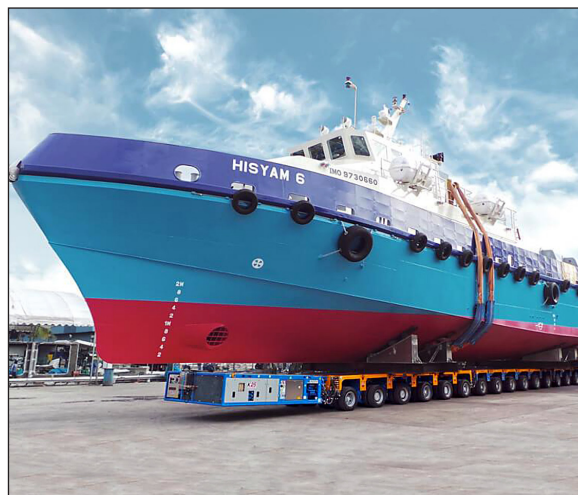
Rys. 8. Transport statku pasażerskiego na wieloosiowej platformie samojezdnej [Transport statku pasażerskiego...]
