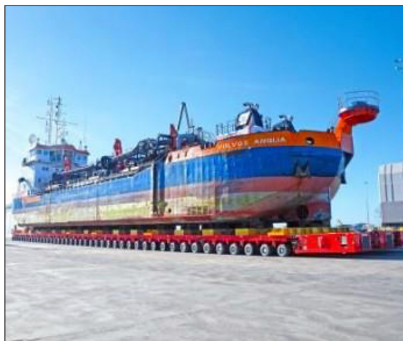
Rys. 7. Transport statku towarowego na wieloosiowej platformie [Transport statku towarowego...]
